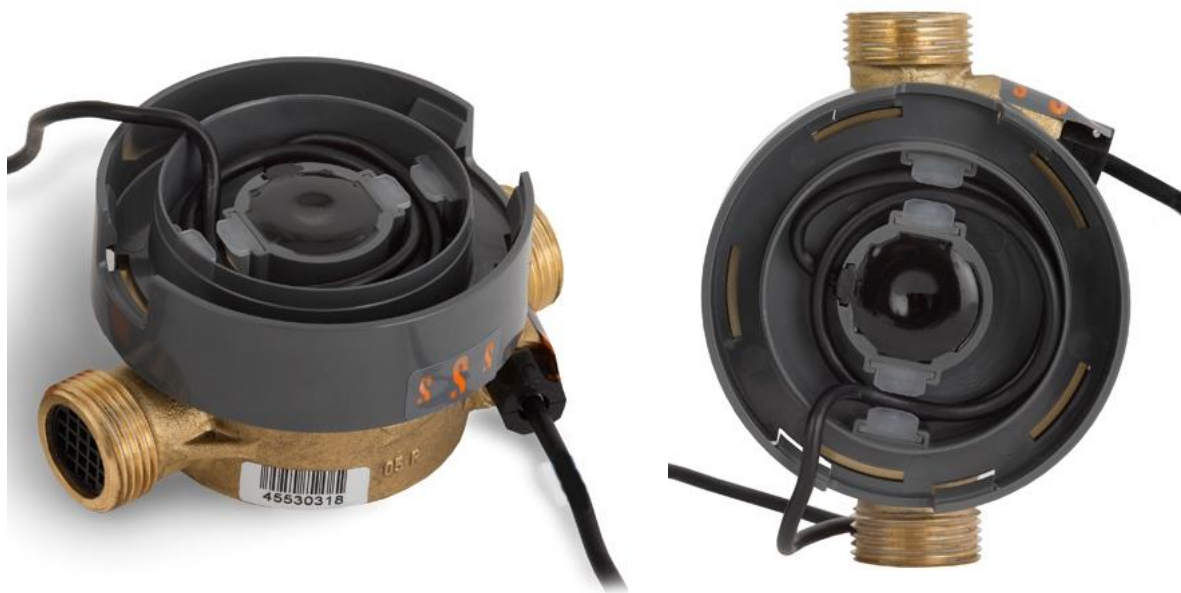
Abbildung 4 – Durchflusssensor (Einstrahlzähler) und Temperaturfühler werden mittels Sicherungskleber versiegelt
