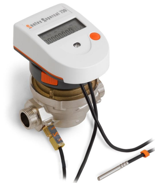
Abbildung 3 – Kompaktwärmezähler SUPERCAL 739, Mehrstrahlkapselzähler für Anschlussstücke mit M77x1.5 Gewinde
