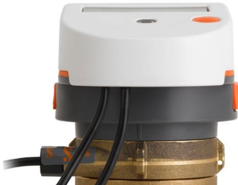
Abbildung 5 – Durchflusssensor (Mehrstrahl-Messkapsel) kann nicht zerstörungsfrei entfernt werden und die Temperaturfühler werden mittels Sicherungskleber versiegelt
