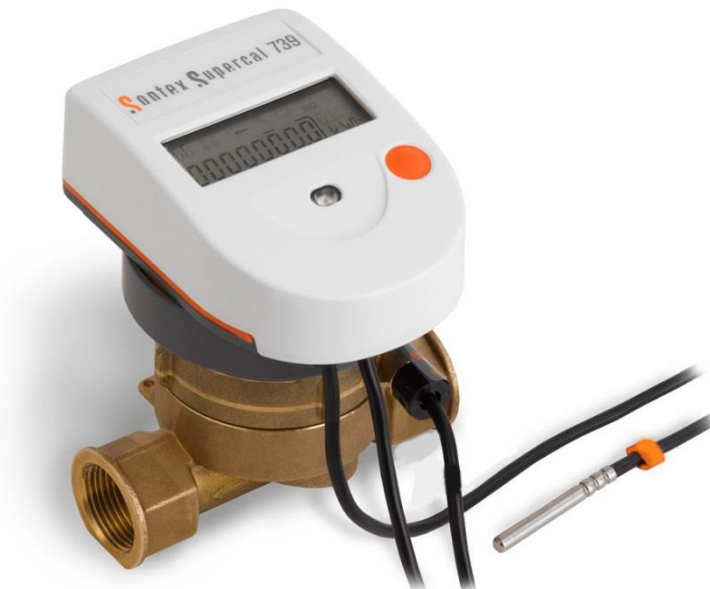
Abbildung 2 – Kompaktwärmehzähler SUPERCAL 739, Mehrstrahl-Messkapselzähler für Anschlussstücke mit G 2“ Gewinde
